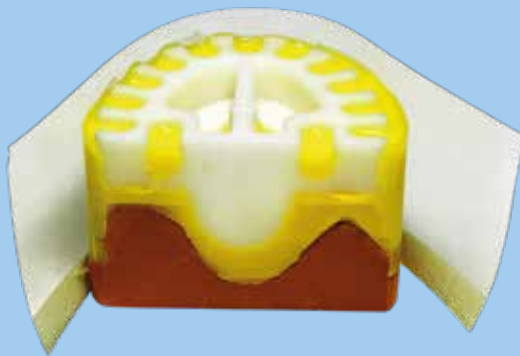
Querschnitt durch eine küvettenlose Dublierung
